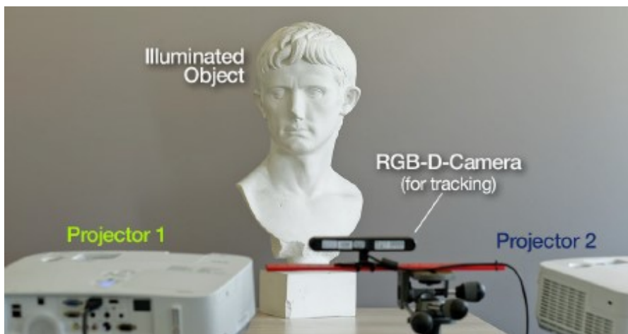
Εικόνα 3-3: Μονάδα προβολής με δύο προβολείς και κάμερα ορατού φωτός - βάθους για τον εντοπισμό του στόχου (Siegl et al., 2015)
